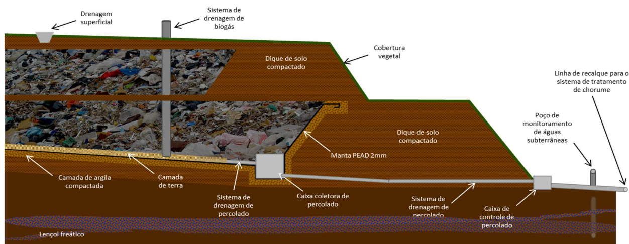
Figura 8: Arranjo geral de um aterro sanitário.
