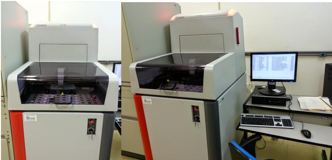
Figura 16. Difrator de Raio-X Bruker D4 Endeavor em funcionamento (CETEM)
