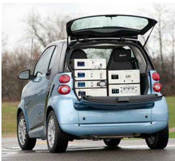
Figura 12 - Veículo equipado com dispositivo para medição das emissões a bordo.
