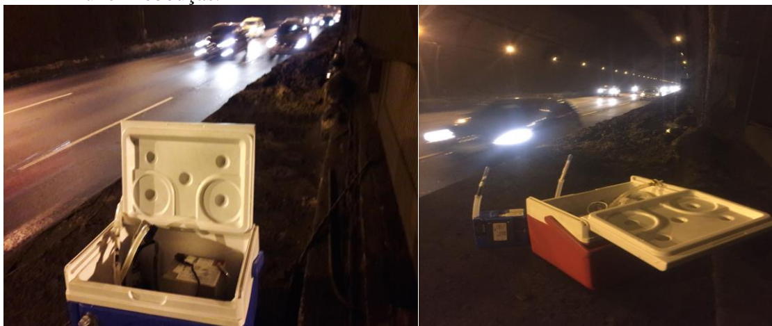
Figura 22 - Bombas de amostragem instaladas sobre a mureta localizada no interior do Túnel Rebouças.
