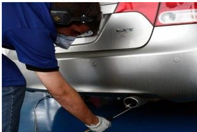
Figura 16 – Instalação do ponto de coleta para realização do teste estático para cálculo da taxa de emissão veicular.
