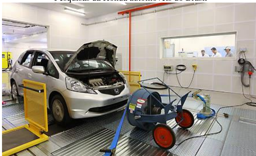
Figura 15 - Teste de dinamômetro de chassis realizado nas dependências do Centro de Pesquisas da Honda automóveis do Brasil
