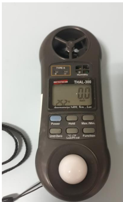
Figura 23 – Anemômetro portátil utilizado nas campanhas de monitoramento dentro do túnel Rebouças.
