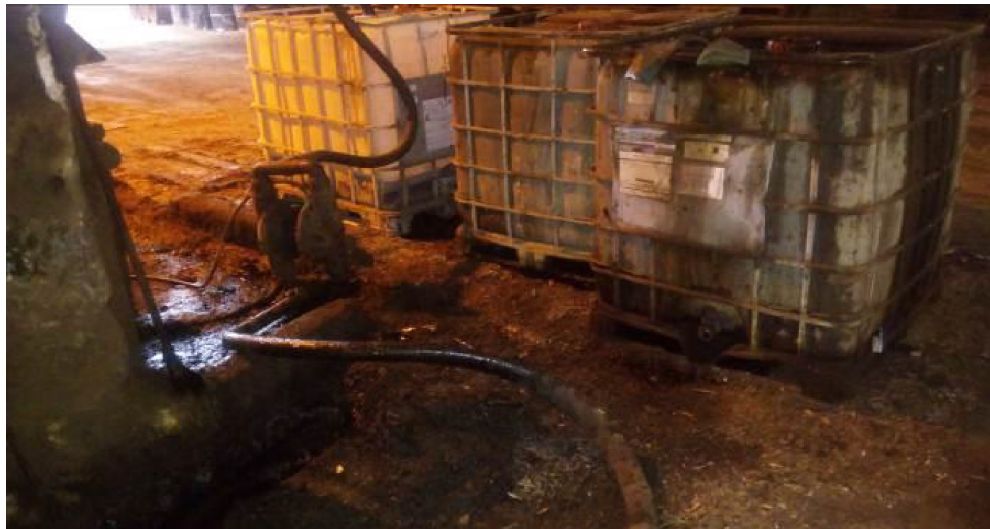
Figura 27: Bombeamento de resíduos líquidos para blendagem
