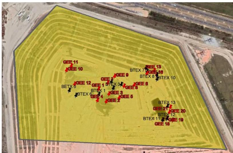
A escolha dos pontos para a coleta de gases na camada de cobertura intermediária do platô superior do ASS foi realizada levando em consideração imperfeições na camada de cobertura, de maneira a recobrir a maior área do platô superior do aterro. Com isso, foram coletadas amostras em pontos com fissuras e em pontos onde a superfície da camada estava íntegra.
