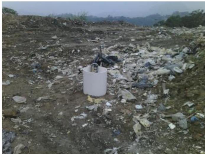
O ponto P1 estava situado a cota de 35 metros acima do nível do mar. A camada de cobertura havia sido implantada há 4 anos e apresentava uma espessura de 55 cm. O ponto P2 estava a 17 metros do nível do mar e a camada de cobertura havia sido implantada há 6 meses e apresentava espessura de 60 cm.
