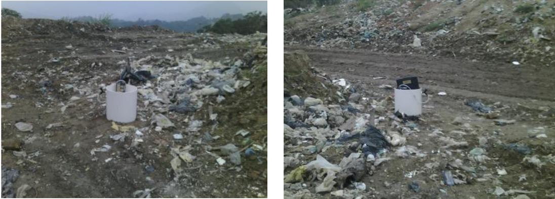
A coleta das amostras de biogás camada de cobertura foi realizada utilizando câmara PVC, com volume de 30 L, diâmetro de 40 cm e altura de 24 cm. A fim de melhor selar a câmara de fluxo no momento da cravação, de forma a proteger principalmente as extremidades, esta foi enterrada no solo até 5 cm de profundidade. Foi instalada uma válvula posicionada no fundo da câmara para retirada das amostras.
