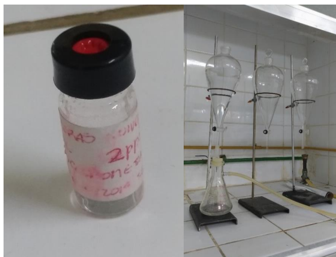
Figura 20 - Padrão utilizado para fortificar amostras de água no funil de separação de 1 L Fonte: O autor, 2021.
