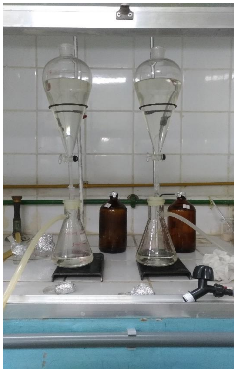
Figura 14 - Sistema de filtração montado a partir de kitassato, funil de separação e bomba à vácuo de teflon
