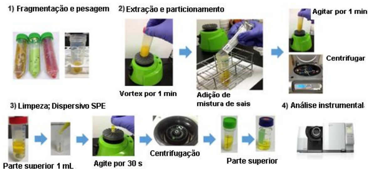
Figura 10 – Diagrama simplificado do processo QuEChERS Fonte: Kim et al. , 2019.
