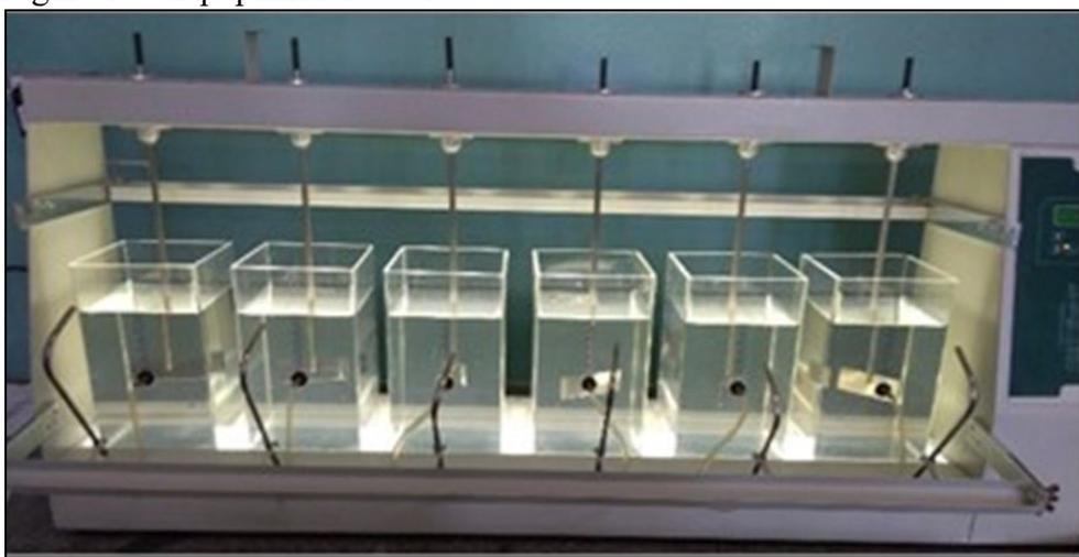
Neste trabalho foram realizados estudos para otimizar a dosagem dos coagulantes utilizada no tratamento de água nas condições de mistura rápida e lenta no tratamento de água onde se examinou a estrutura do floco, tamanho e sua formação. A faixa de concentração escolhida foi aquela que permitiu a formação do melhor tipo de floco, a melhor clarificação e a
