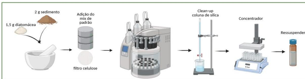
Figura 13: Etapas do método de extração acelerada por solvente com pressão
